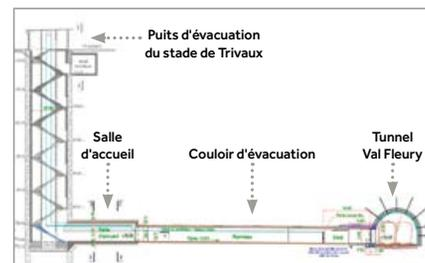
Schéma du puits et couloir d'évacuation du RER C.
