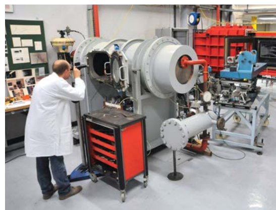
Préparation dans la soufflerie S5Ch. Calage angulaire du roulis d'une sonde anémoclinométrique à 7 trous, par visée cathétométrique dans le banc d'étalonnage de sondes dans la soufflerie S5Ch. |
