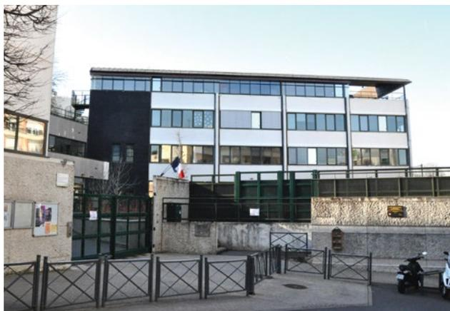
**Au groupe scolaire Perrault-Brossolette**, les travaux ont porté sur l'étanchéité, l'ajout de brise-soleil orientables, le remplacement des luminaires, la réfection des sanitaires élèves, la rénovation des classes, des circulations et du préau (peinture, plafond, luminaires leds), le nettoyage des réseaux de ventilation existants, l'amélioration du système de ventilation en façade. Coût global des travaux : 1,125 M€, dont 43625 € environ sont dédiés à la rénovation énergétique.
