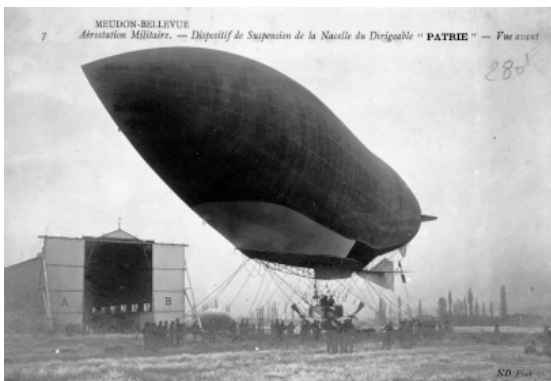
Dispositif de suspension de la nacelle du dirigeable Patrie 1Fi 941
